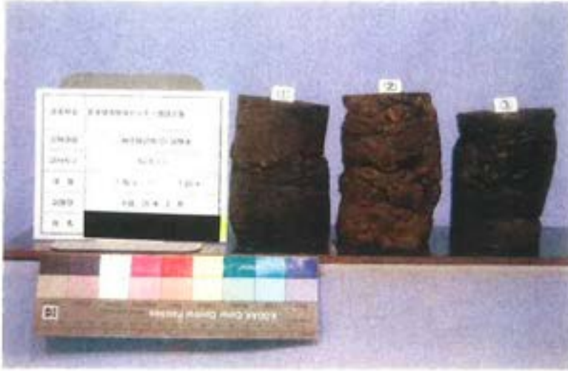
三軸圧縮試験(CU) 試験後
