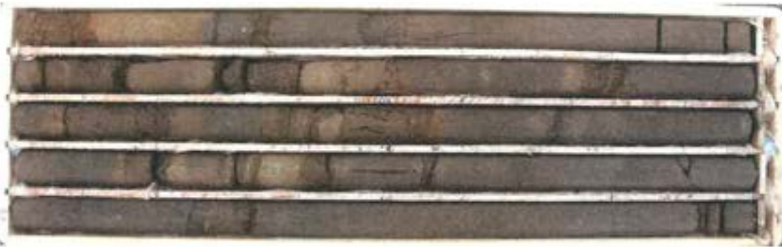
図 3.3-5 No.3 ボーリングコアの深度 25m～30m 間。Ms2 と区分した地層が連続する。大部分は泥岩からなり、所々に砂岩の薄層をはさんでいる。
