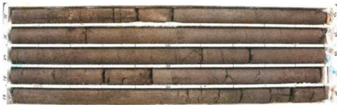
図 3.3-10 No.7 ボーリングコアの深度 25m~30m 間。Alt2 と分類した砂岩と泥岩の互層が連続する。
