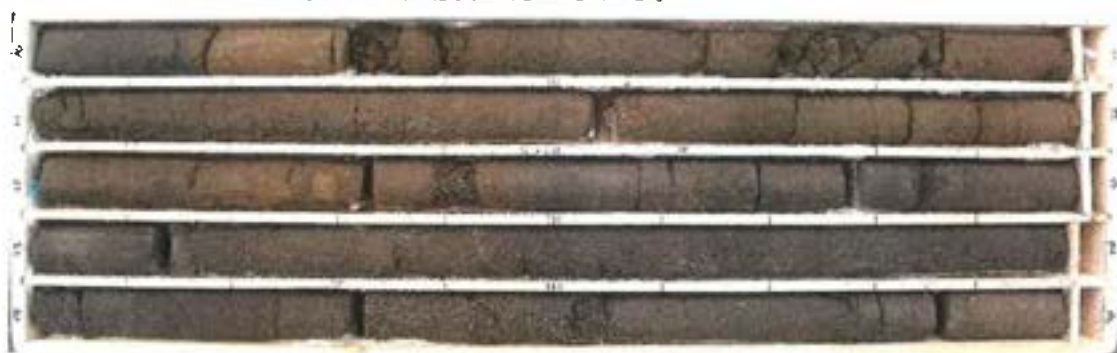
図 3.3-9 No.7 ボーリングコアの深度 10m~15m 間。Ms3 と分類した地層。
