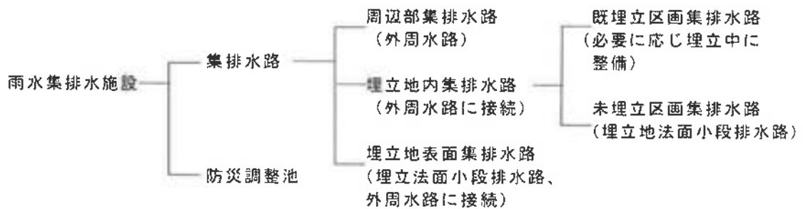
図2-3 4.11 雨水集排水施設
