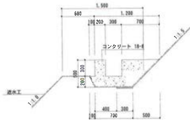
図5-3 埋立地内集排水路
