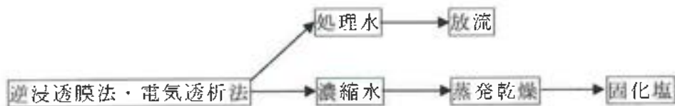
図 2 - 8 脱塩処理工程
