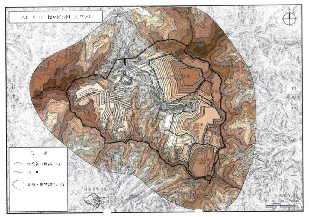
きらに、事業の実施に伴う地形区分の変化についてみると、調査地域及び事業 実施区域における増設埋立施設完成時(埋立前)の地形区分の状況は図8 8.17 に、地形区分の変化の程度は表8-8.13(1),(2)に示すとおりである。調査地域で は、埋立前・埋立後は人工改変地(埋立地等)が13.3%増え、凸型急斜面が5.9% 減少する。また、事業実施区域では、埋立前・埋立後は人工改変地(埋立地等) が32.5%増え、凸型急斜面が15.3%減少する。
