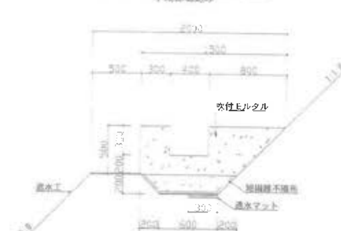
固定工A'B-400 (1:1.0) 排水小段部 小段部掘込み
