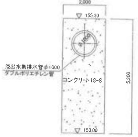
Ⅲ-2埋立地浸出水集水ピット構造図(3)
